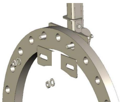
Рис. 7. Установка устройства на фланце (патрубок фланца условно не показан)
